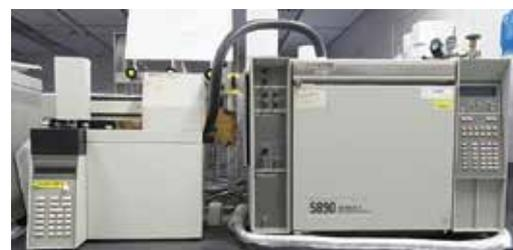
写真1：ヘッドスペースガスクロマトグラフ分析装置
