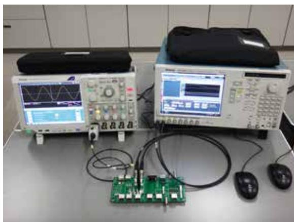
写真2：イーサネットコンプライアンス試験装置
