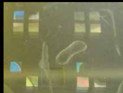
写真5：6回目のナノインプリントにより転写した樹脂上のパターン
