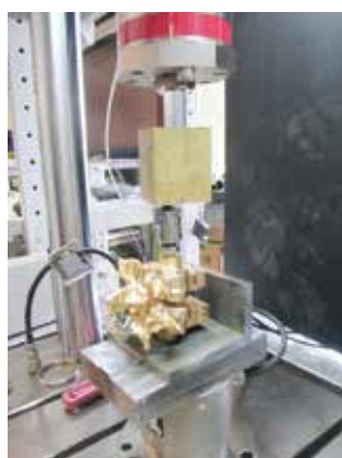
図1: 3D金属造形製品の疲労試験の様子
