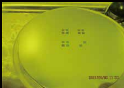
写真4：試作したナノインプリント用金型
