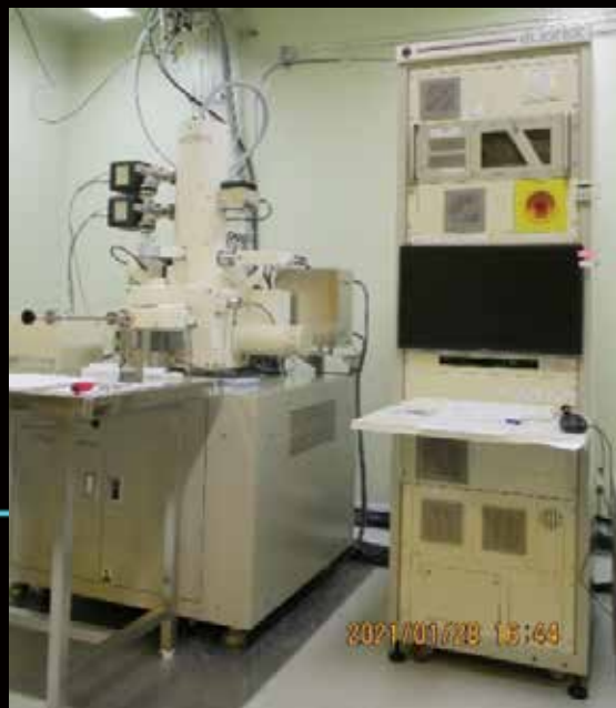
写真3：使用した電子線描画装置（ELS-S50）
