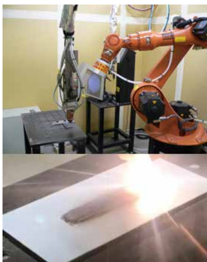
図1: LMD装置と加工時の様子
