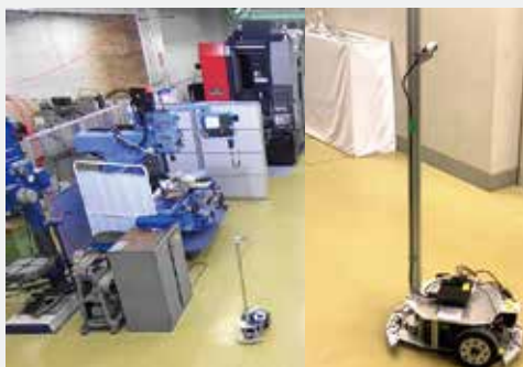
図3 工作機械の巡視に向かう台車ロボット (左) 台車ロボット (右)
