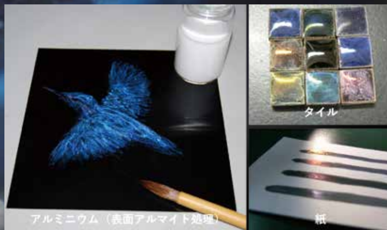
写真2 様々な基材に人工オパールを塗った様子；筆で水彩画を描くように使うこともできる。
