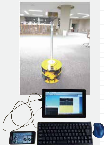
図4 移動式の5G (サブ6) 対応電波測定システム
