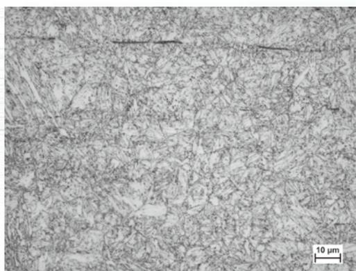
図1：機械構造用合金鋼の調質材（282HV0.1）
