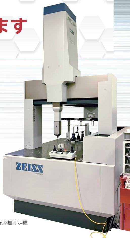
写真1：接触式三次元座標測定機
