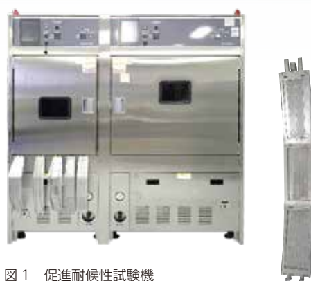
図1 促進耐候性試験機 (右：サンプル設置の様子)
