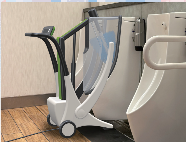
図4：最終デザイン(採算性・機動性等に配慮した半自動清掃ロボット)
