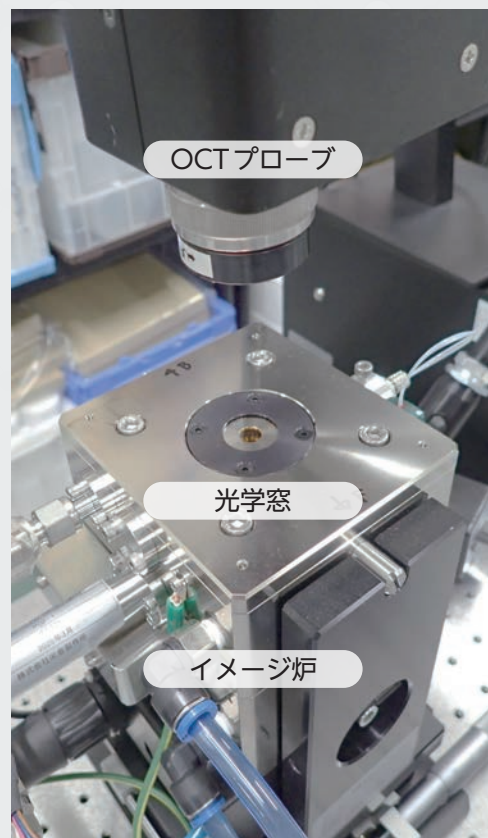
図3：高温オペランド観測システム
