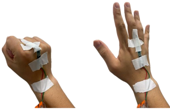
図 8 曲げセンサによる指関節の動作計測
