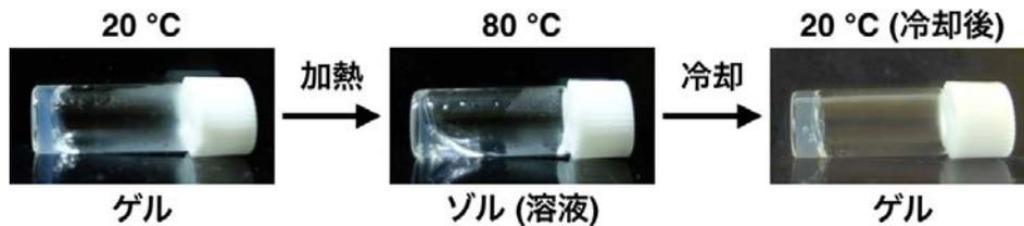
図3. A8G の温度応答性。加熱によりゲルからゾルへ転移し、冷却すると再びゲルに戻る。
