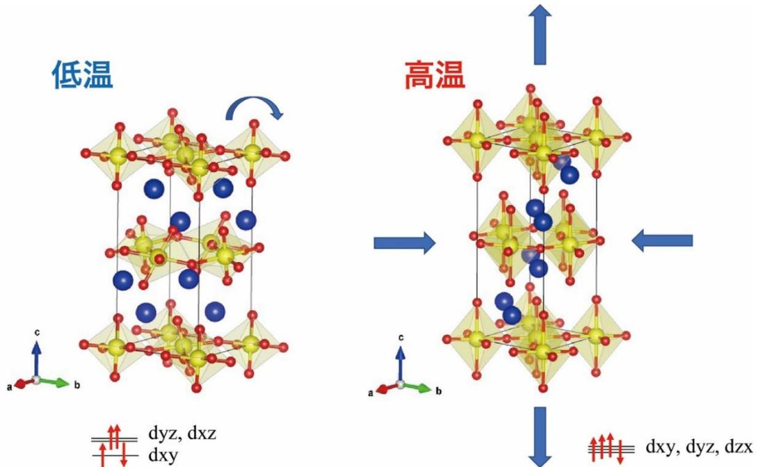
図 1  $\text{Ca}_2\text{RuO}_4$  の低温(左)と高温(右)の結晶構造。低温では  $d_{xy}$  軌道のみが 2 つの電子を持つため、酸素 8 面体が横に伸びている。8 面体が傾斜することでも c 軸(縦)方向に収縮している。昇温すると、これらの歪みが解消することで、c 軸(縦)方向に膨張、b 軸(横)方向に収縮する。
