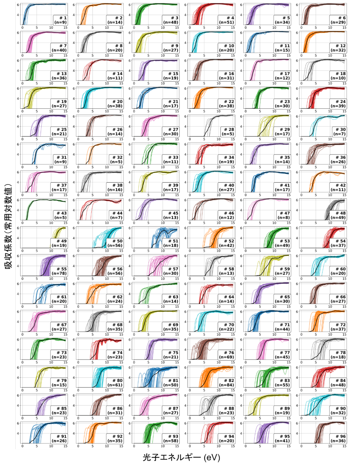
図2 深層学習に基づいて96グループに分類した物質の光吸収スペクトル。スペクトルデータの直接的な分類でないにもかかわらず、各グループ内でスペクトル形状が類似している。
