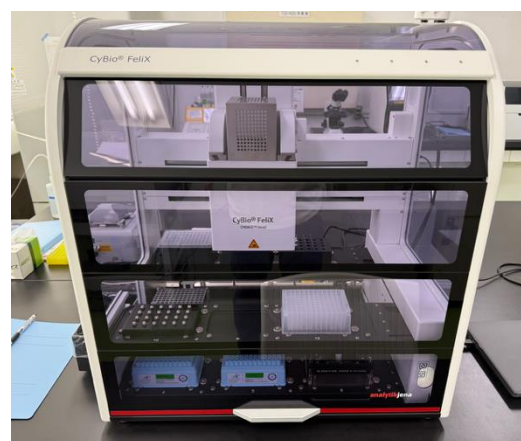
図 2. DNA フラグメント精製ステップを自動効率化するために活用した CyBio FeliX (Analytik Jena 社) 96 サンプルを同時に取得分注できる移動式ヘッドが 1 つ搭載された装置。
