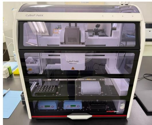
図 2. DNA フラグメント精製ステップを自動効率化するために活用した CyBio FeliX (Analytik Jena 社) 96 サンプルを同時に取得分注できる移動式ヘッドが 1 つ搭載された装置。
