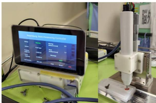
図3 プローブ型測定器での硬さ評価
