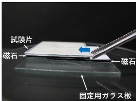
図2：磁石を用いた試験片の固定
