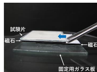
図 3 磁石を用いた試験片の固定
