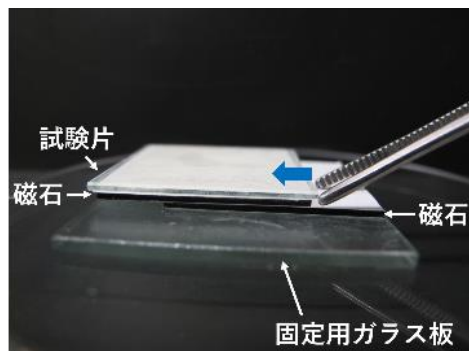
図2：磁石を用いた試験片の固定
