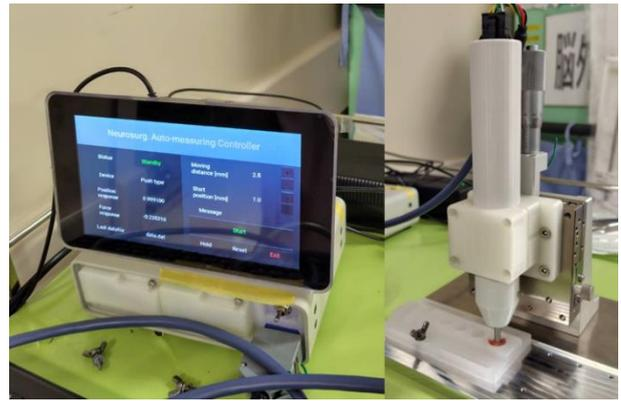
図3 プローブ型測定器での硬さ評価
