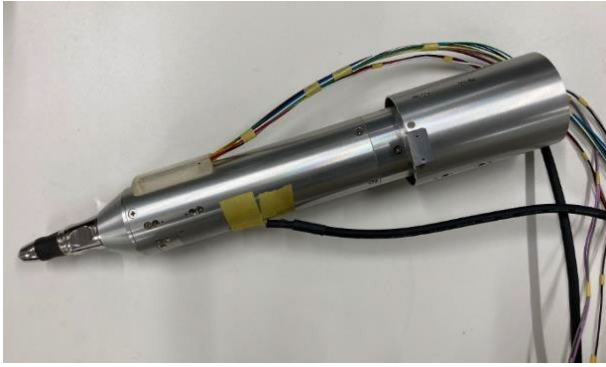
(a) ハプティック骨ドリル改良試作機
