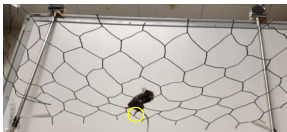
図 3：歩行機能テスト マウスを亀甲金網の上に置き、動画を撮影する。黄色の丸印で示した足の踏み外しを観測者が BORIS ソフトウェア上で記録し、総歩数に対する足の踏み外し割合を算出する。
