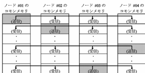
図2 FL-netのデータ共有機能の例
