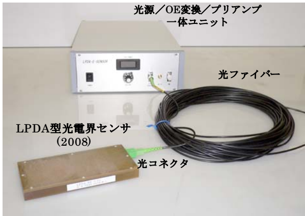
図 5 LPDA 型光電界センサ(2008)
