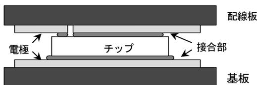
図1 パワーデバイス実装構造の断面模式図
