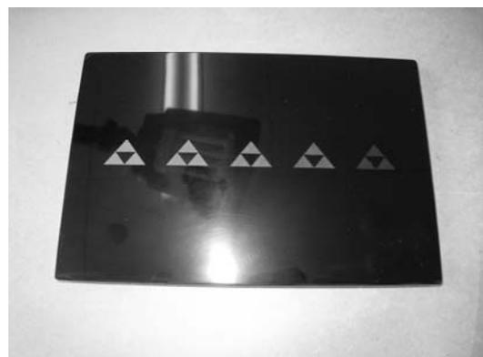
写真2 レーザー加工機による模様付け
