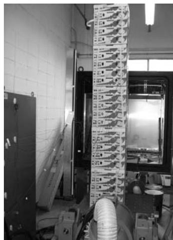
図1 振動試験機による積荷の実験モード解析
