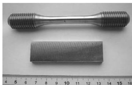
図3 上：丸棒型試験片 下：平板試験片
