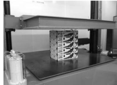
図6 箱の圧縮試験
