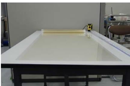
図3 非晶質炭素を被覆した PET シート(幅 450mm×長さ 3m)
