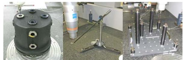
図 1 左より、クオリティ・マスター、マシン・チェック・ゲージ、簡易検査ゲージ (産総研)
