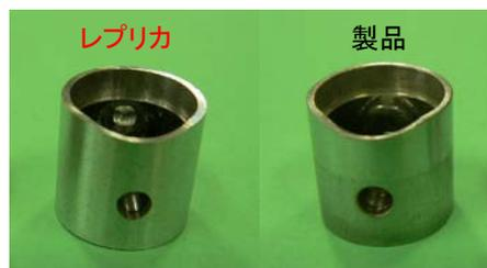
図3 製作したピストンレプリカと製品
