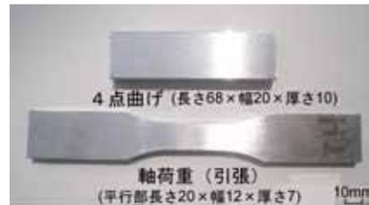
図1 4点曲げ試験片と軸荷重試験片
