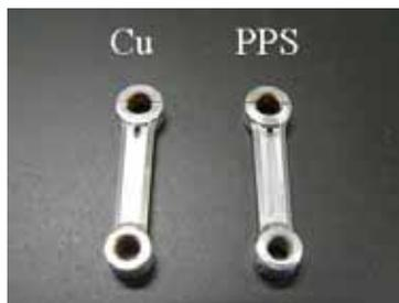
図2 製作した改良コンロッド
