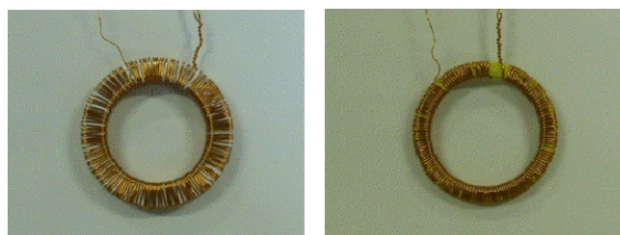
a) ケースに入れた場合 b) 試料に直接巻いた場合
