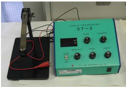
図1 電解装置(電解式膜厚計)
