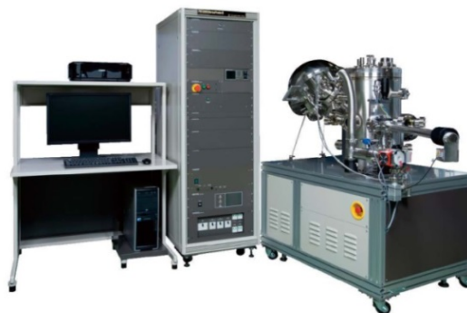
図 2 X 線光電子分光装置
