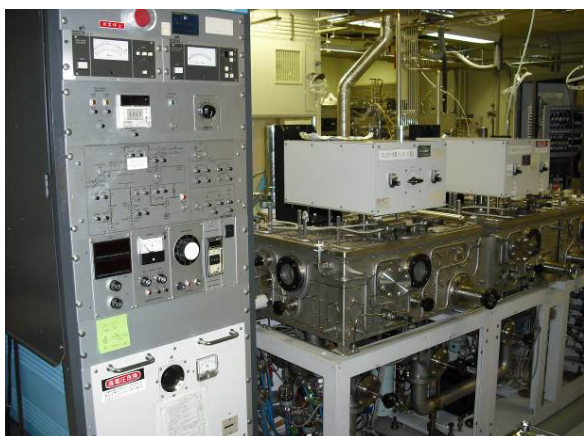
図2 ドライエッチング装置外観
