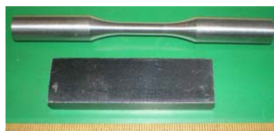
図 1 丸棒試験片(φ6)と平板試験片(t10)
