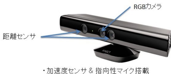
図 1 Kinect のセンサ
