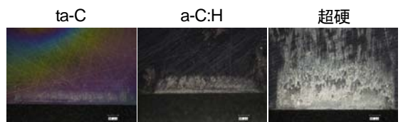
図 4 断続切削後の工具すくい面の状態 1 mm
