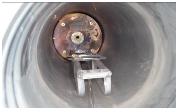
図2 熱CVD装置の炉内の様子（基板横置き）
