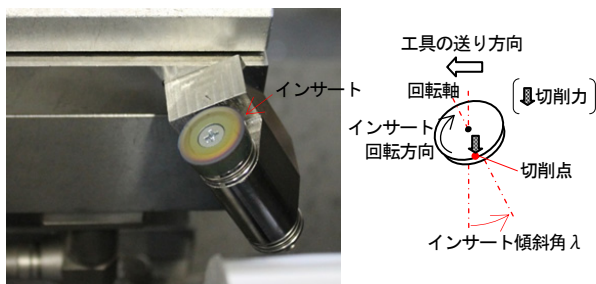
図1 製作したロータリ工具とインサート回転の原理
