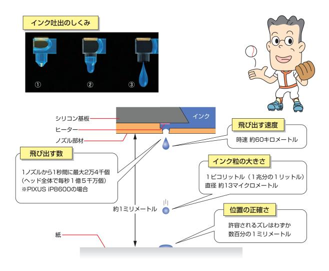
プリントヘッドにあるノズルから飛び出すインクの粒は、ダイナマイト並みの力で押し出され、時速60キロメートルものスピードで紙に向かって飛び出します。飛び出してから紙に届くまでの時間はわずか1万分の1秒以下。一つひとつのノズルは、このような高速なインクの粒を1秒間に24000個も飛び出させることが可能です。また、このとき飛び出したインクの粒の衝突する位置は、1ミリの100分の1のずれも許されません。
