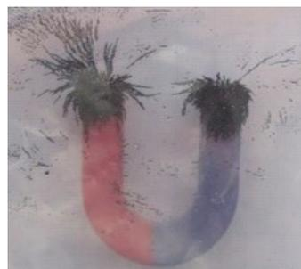
図1 U字フェライト磁石と砂鉄
