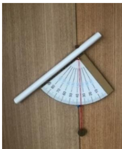
北極星の高度測定用象限儀
