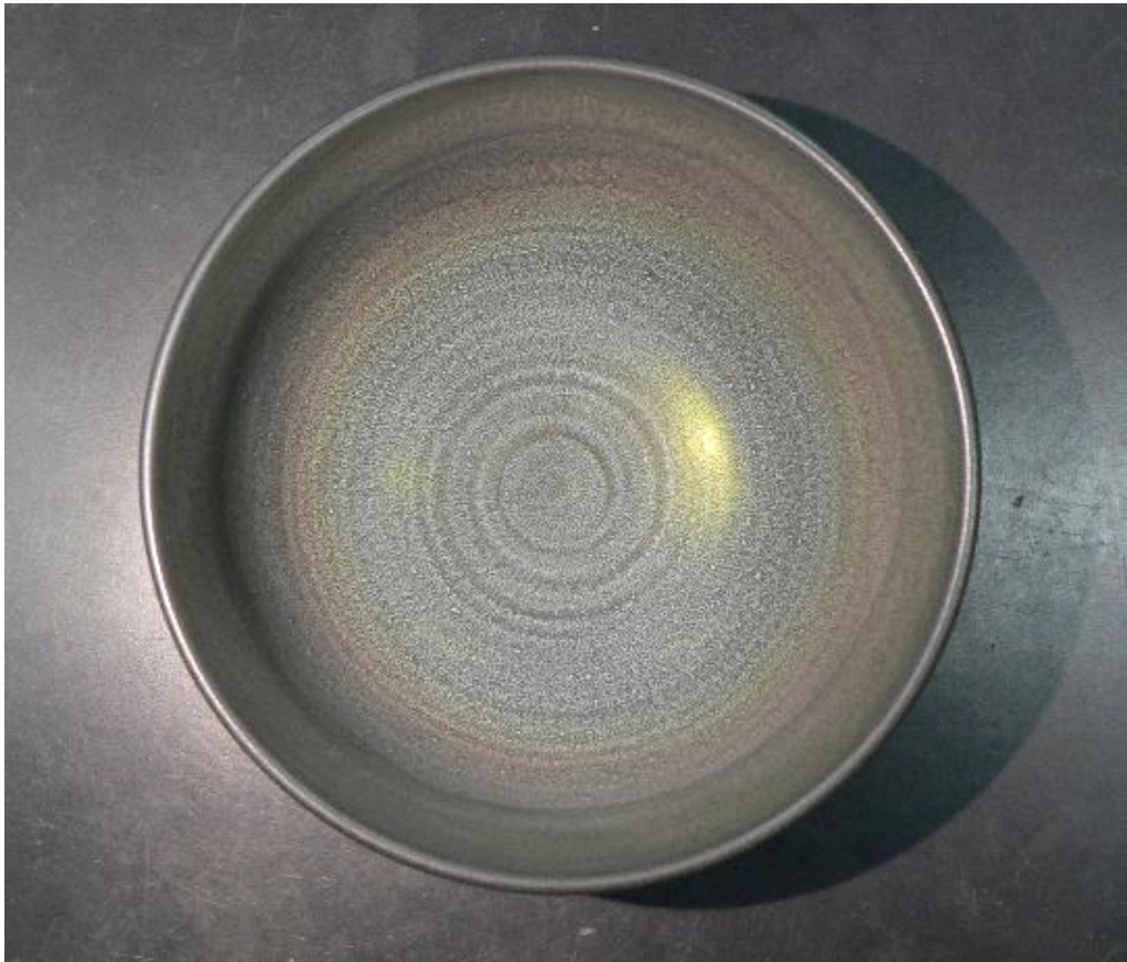
図5 同心円状の虹色をデザインした試作品. 用いた人工オパールは1種類. 陶器の内側の傾斜により光の角度が異なるため、赤色～緑色の異なる色が見える.
